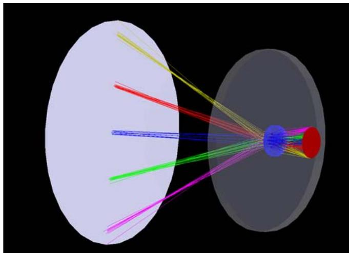
Die fünf LED's der Ladestands-anzeige werden mit einer plan-konvexen Linse auf eine Bildebene projiziert (z.B. auf eine Hand). So kann man den verbleibenden Akkustand ohne weiteres ablesen.
